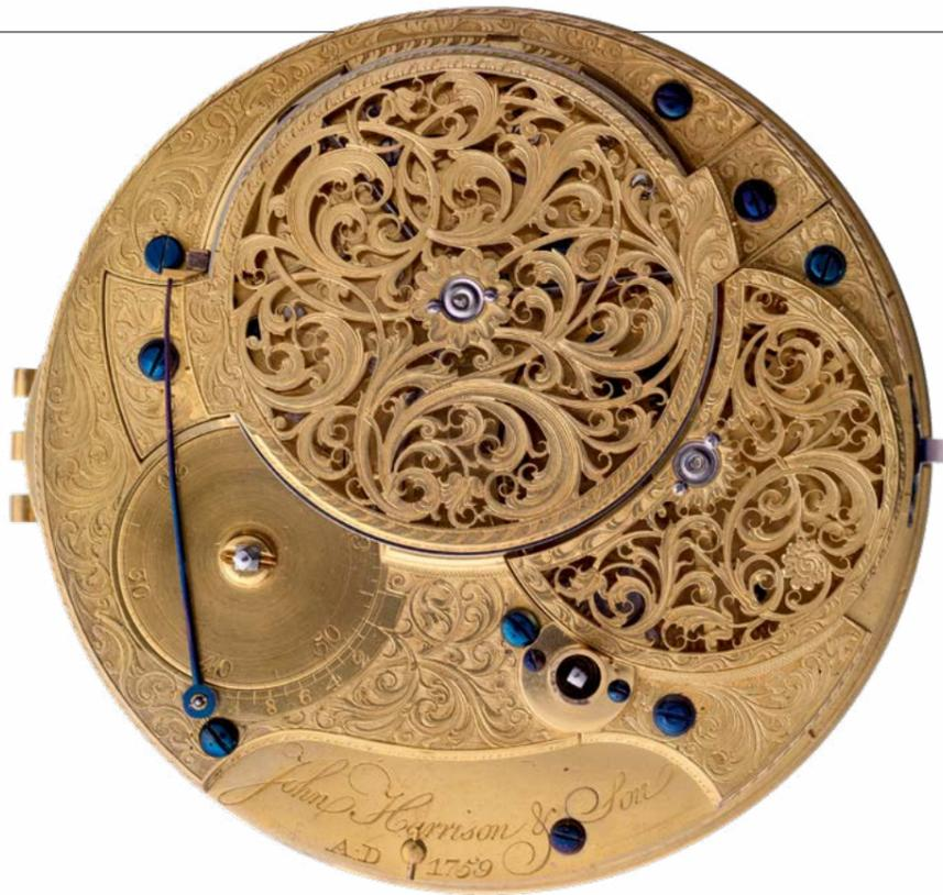
*Mouvement du chronomètre de marine H4
