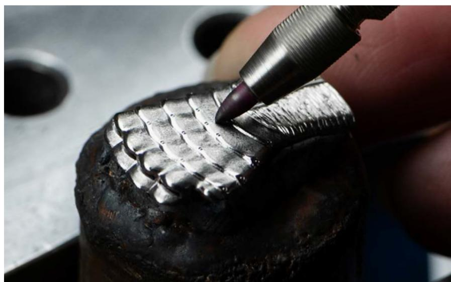
Travail de terminaison et de finition avec différentes gommages sur un micromoteur.
