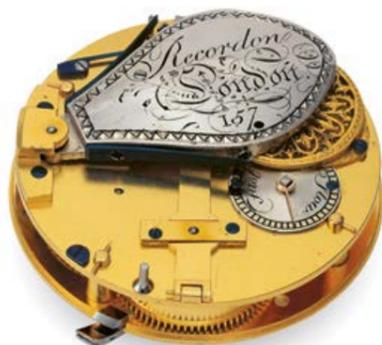
Montre en or et émail à remontage automatique avec masse oscillante en platine en forme d'ogive, boîtier N° 7181, gravé Recordon, Londres.
