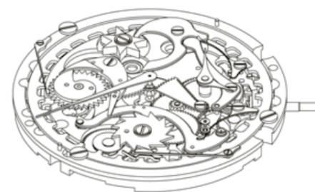
*Inséré dans un espace d'une hauteur de 1 mm, le calendrier annuel rétrograde est la troisième complication à être intégrée dans le calibre Octa Automatique.*
