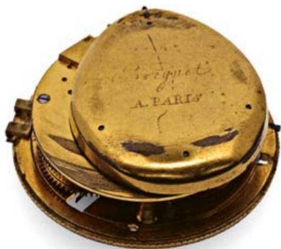
Mouvement signé Breguet à Paris. Vue de la platine arrière et de la cadrature du mouvement.
