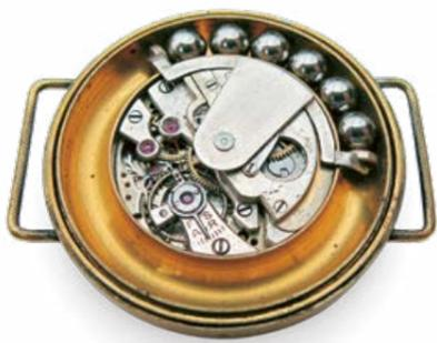
Prototype d'une montre ronde de Léon Hatot et vue de la masse de remontage entièrement constituée par des billes d'acier.
