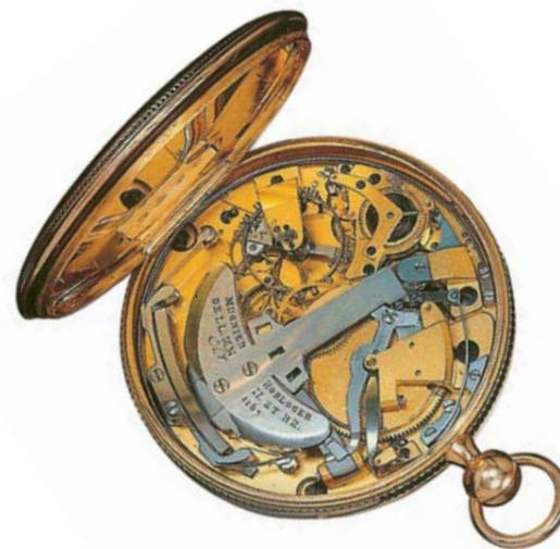
Montre Charles Mugnier N° 1167 en or faite pour Napoléon 1<sup>er</sup> avec répétition des demi-quarts, petites secondes et masse oscillante de platine noyée dans l'épaisseur du mouvement.
