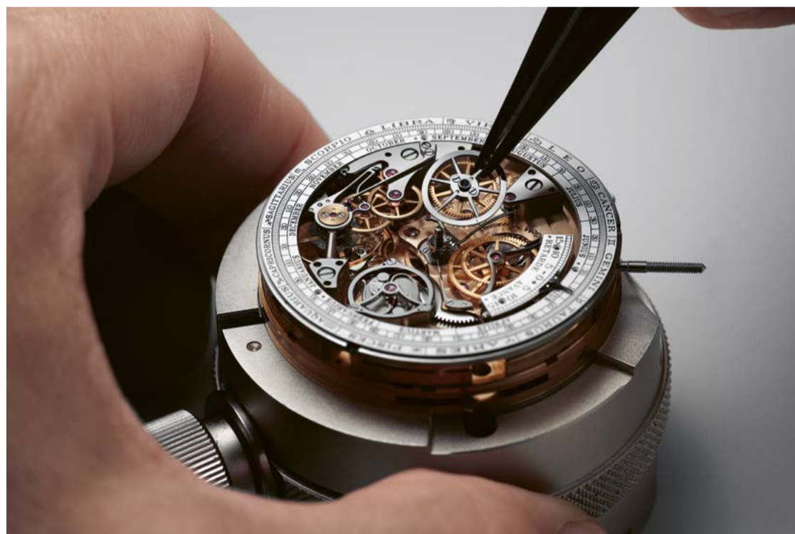
Mise en place de la came de l'équation du temps au dos du mouvement de l'Astronomic Souveraine.
