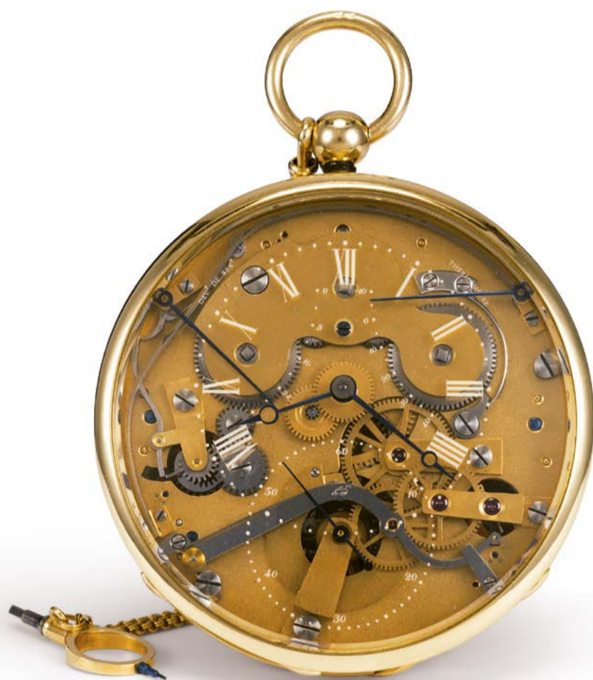
Tourbillon à Remontoir d'Égalité - 3/84 Tourbillon à détente avec remontoir d'égalité, réserve de marche et thermomètre, boîtier en or, double fond, diamètre 70 mm, cadran en saphir gravé et aiguilles Breguet en acier bleui. Gravée FAIT POUR LE D r E. GSCHWIND, achevée en 1984.
