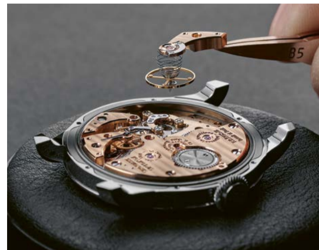
Assemblage du balancier et de son pont sur le mouvement du Chronomètre Optimum. L'horloger peut ensuite ajuster l'organe régulateur, point d'équilibre du mouvement, en interaction avec l'échappement EBHP.
