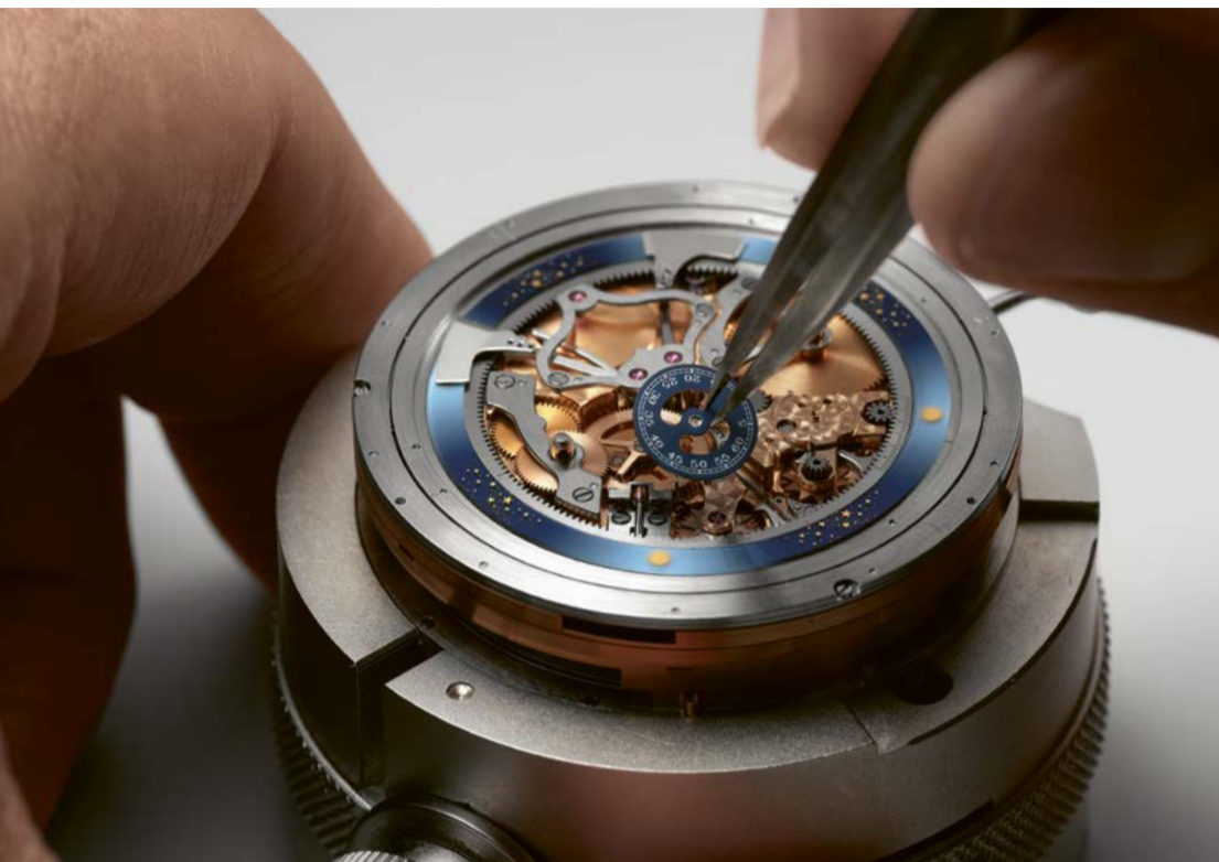
Positionnement et ajustement du disque des secondes lors de l'assemblage du mouvement de l'Astronomic Souveraine.
