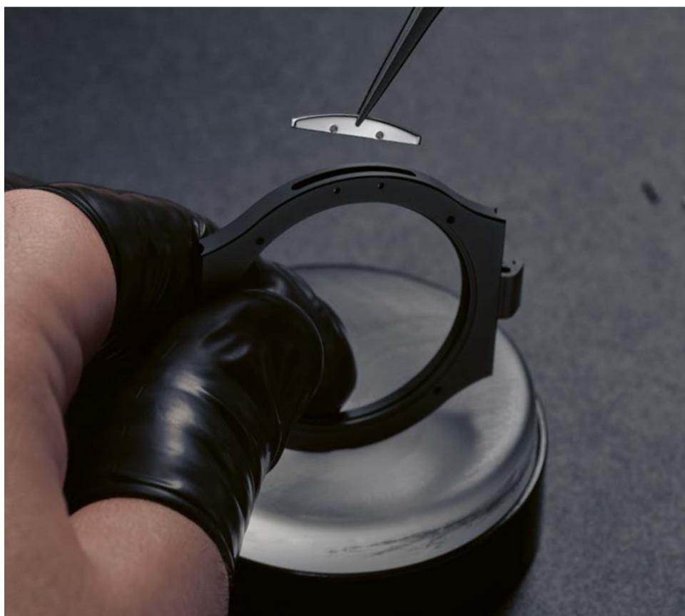
Montage des inserts en tantale sur la carrure du Chronomètre Furtif.
