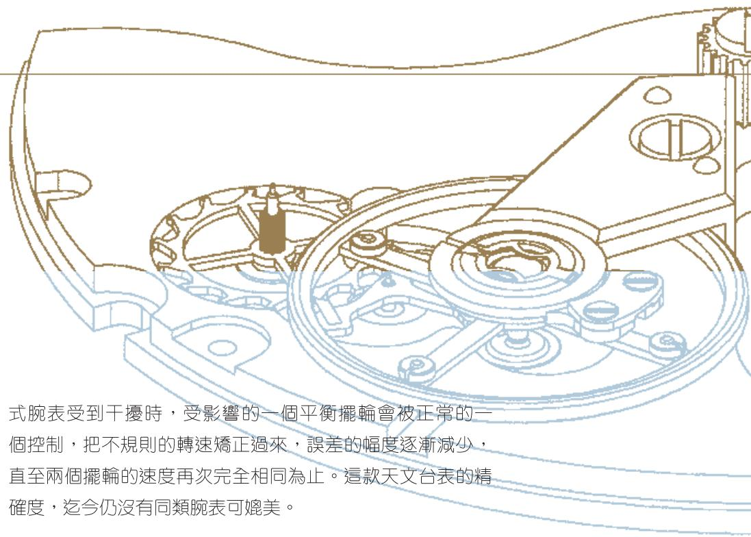
式腕表受到干擾時，受影響的一個平衡擺輪會被正常的一個控制，把不規則的轉速矯正過來，誤差的幅度逐漸減少，直至兩個擺輪的速度再次完全相同為止。這款天文台表的精確度，迄今仍沒有同類腕表可媲美。
