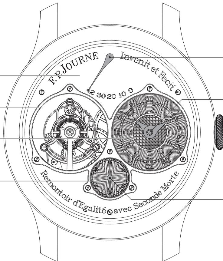
ギョーシェ彫りを施したシルバー製インダイヤルは、18Kゴールド製の文字盤にネジ留めされた鏡面研磨を施したスティール製の枠によって固定されています\*。
