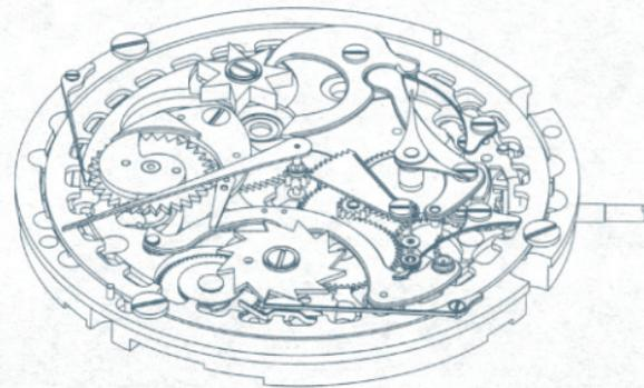
*Mécanisme du calendrier ultra-plat (1 mm)*
