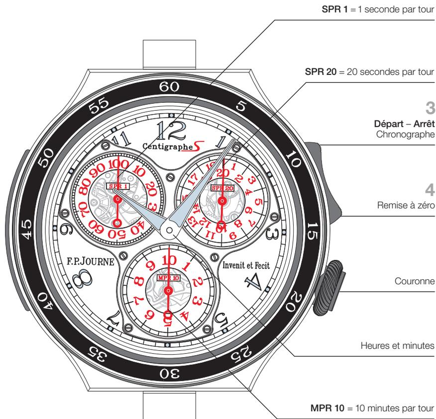
Les cadrans des compteurs en saphir sont maintenus par un cerclage en Titane, vissé\* sur le cadran. \*Système déposé
