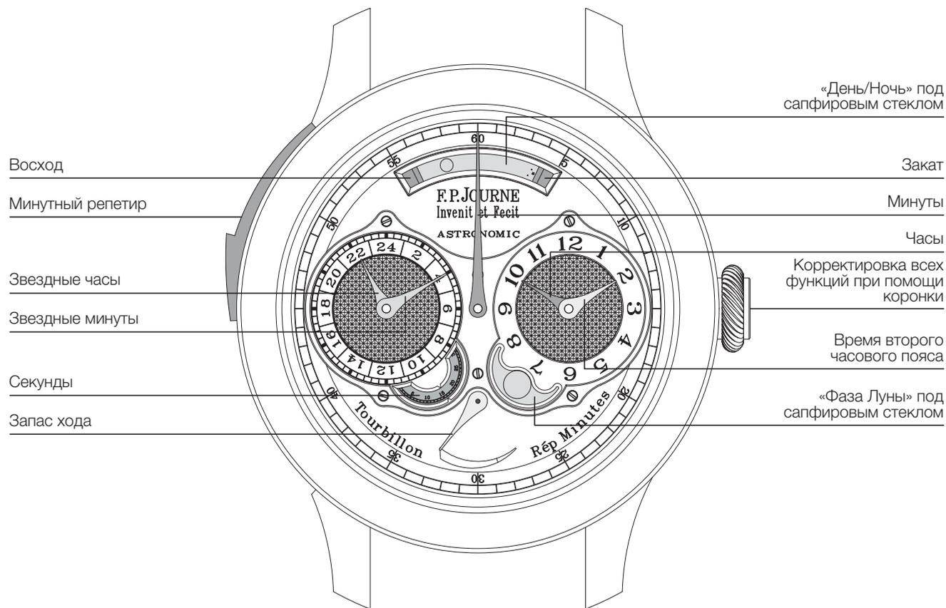
Часовой, секундный и циферблат фазы Луны привинчены\* к основному циферблату при помощи стального кольца.
