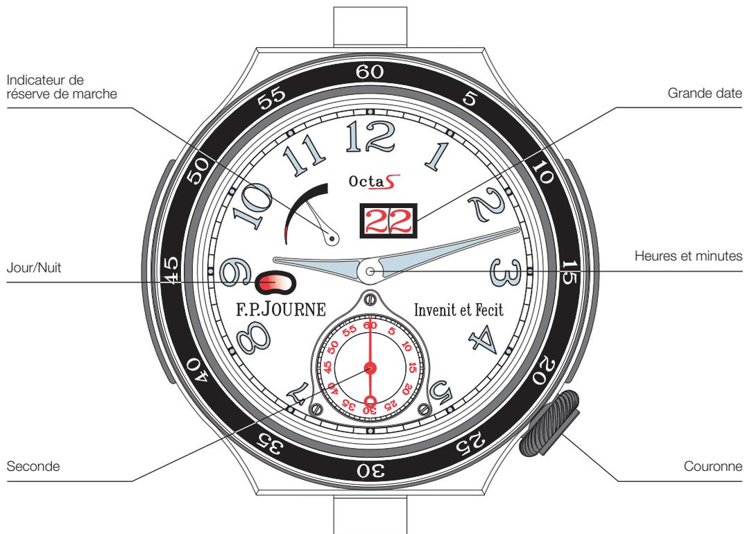
Le cadran des secondes en saphir est maintenu par un cerclage en Titane, vissé\* sur le cadran en Aluminium.
